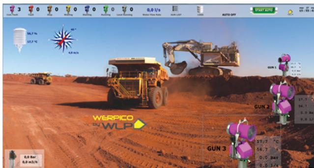
В процессе подавления пыли и запахов на больших или сложных площадках используются комплексы установок, управление которыми эффективней выполняется автоматизировано.
